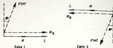
Bild 11. Buntes Feld 8 ( \pm U ) bei falscher Phase des FHT
